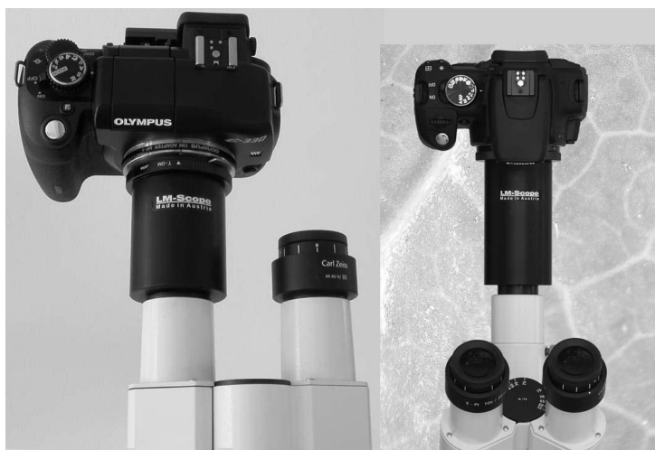
Рис. 1.4. Камера «Olympus» с универсальным адаптером «T-Mount», присоединенным к оптическому микроскопу
