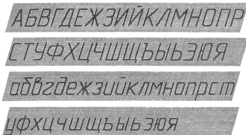
Рис. 67. Шрифт типа А с наклоном (прописные и строчные буквы)
