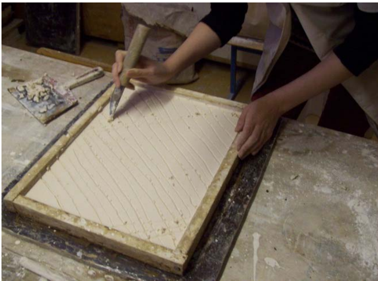
Рис. 28, 29. Изготовление гипсового основания
