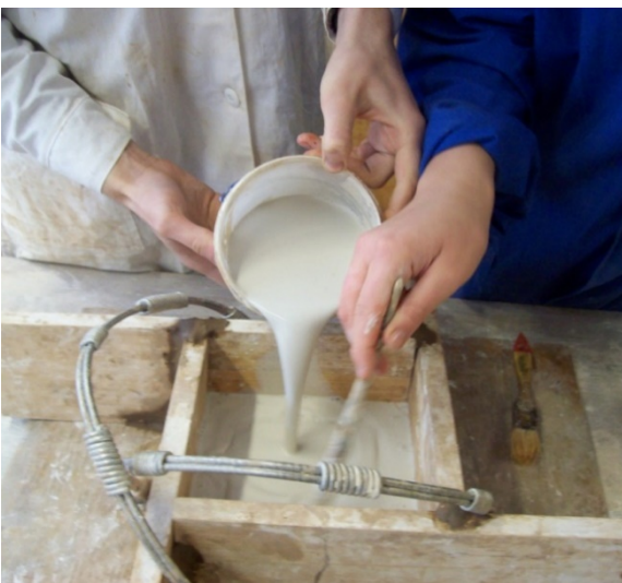
Рис. 17, 18. Отливка и раскалывание формы
