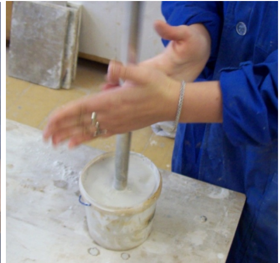
Рис. 15, 16. Приготовление и перемешивание гипсового раствора
