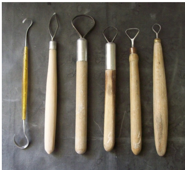
Рис. 4. Заточенные петли или кольца для обработки внутренних поверхностей и выемки гипса
