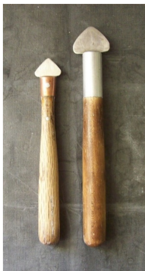
Рис. 5. Режущие инструменты для выполнения замков в формах.
