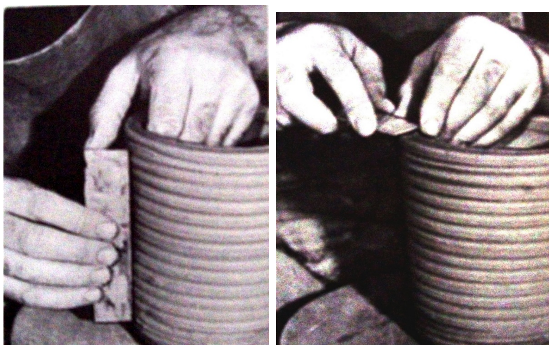
Рис. 27, 28. Соединение и выравнивание стенки формы, формование и обработка горловины
