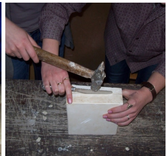
Рис. 17, 18. Отливка и раскалывание формы
