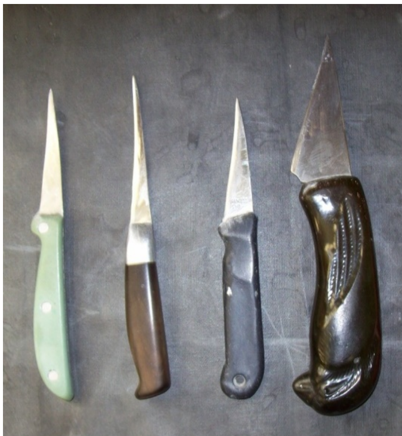
Рис. 3. Ножи для резания гипса при обработке форм, снимаемых с моделей
