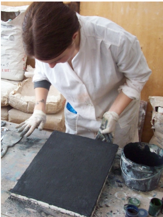
Рис. 30, 31. Нанесение растворов-колеров на основу. Обрезка торцов со всех сторон
