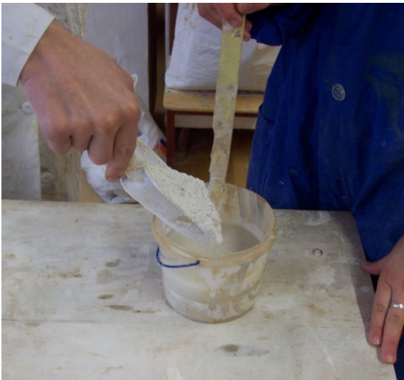
Рис. 15, 16. Приготовление и перемешивание гипсового раствора
