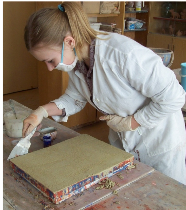
Рис. 30, 31. Нанесение растворов-колеров на основу. Обрезка торцов со всех сторон
