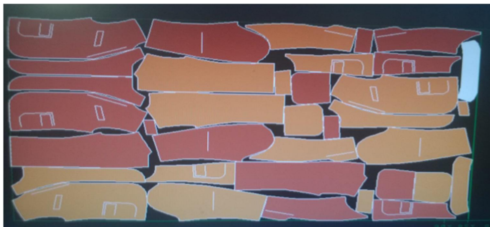
Рис. 6.1. Экспериментальная раскладка лекал мужского пиджака
