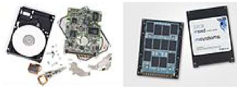
Рис.14.1. Компоненты HDD (слева) и SSD (справа)
