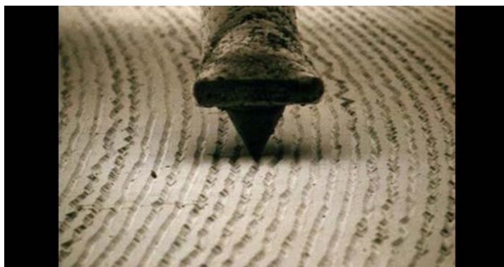
Рис. 9.1. Микрофотография иглы на дорожках винилового диска
